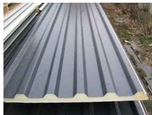
Nieuwe (geïsoleerde) damwandplaten
